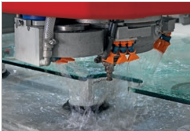
门的完整加工：铣型和凹口磨边，外部磨边和抛光。
